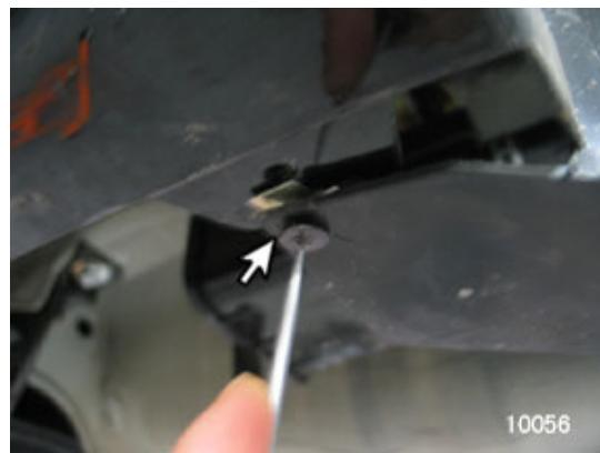
3、打开油箱盖，用起子压出加油管
